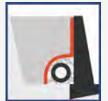
İstinat duvarı drenajları
