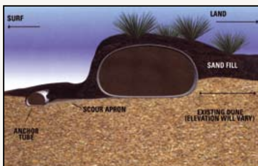
Песчаная дюна с контейнером TenCate Geotube® в основании.
