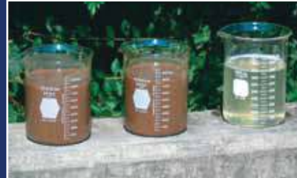
Lumpur sebelum proses (kiri) dan sesudah (kanan) dengan teknologi dewatering Geotube®.
