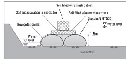
*Cross section of Geotube<sup>Æ</sup> miniñdam*
