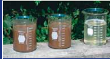
Lodo bruto (à esquerda) e (à direita) após passar pela desidratação promovida pela tecnologia Geotube®.
