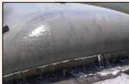
Geotube® desaguando resíduo da agricultura, sistema qualificado pela EQIP.
